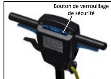
Une fois que vous avez la hauteur de la poignée réglé selon vos préférences et vous êtes dans la position des opérateurs, regarder à droite sur la base de la machine. Vous verrez l'indicateur de démarrage neutre qui indique avec la base de la machine est de niveau en alignant la bulle entre les deux lignes. Appuyez sur le bouton de verrouillage de sécurité avec vos pouces et démarrer la machine en appuyant soit à gauche, à droite ou de préférence les deux leviers de commutation.
